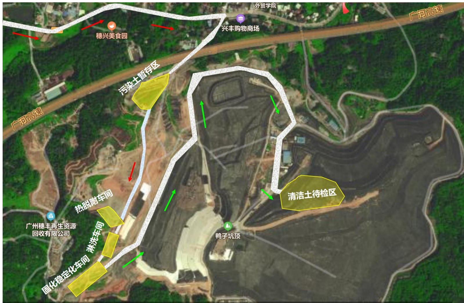
图 5.6-3 一期试点各功能区平面布置和土壤转运图
