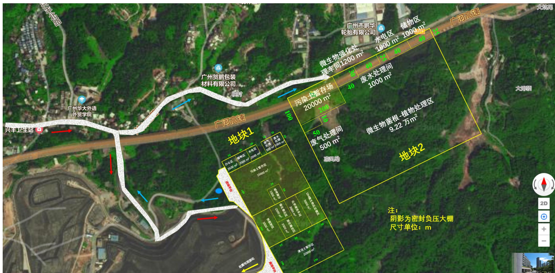
图 5.6-4 修复中心二期平面布置与转运路线图
