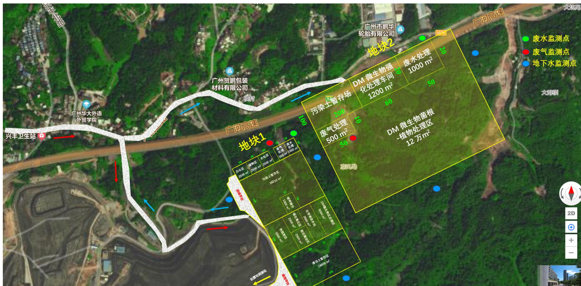
图11.1-9 修复中心二期物联网环境监测布点位置图
