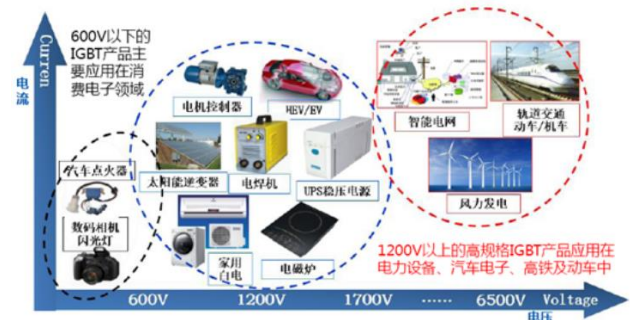
图 29：按电压分布的 IGBT 应用领域，高端主要用于 1000V 以上
