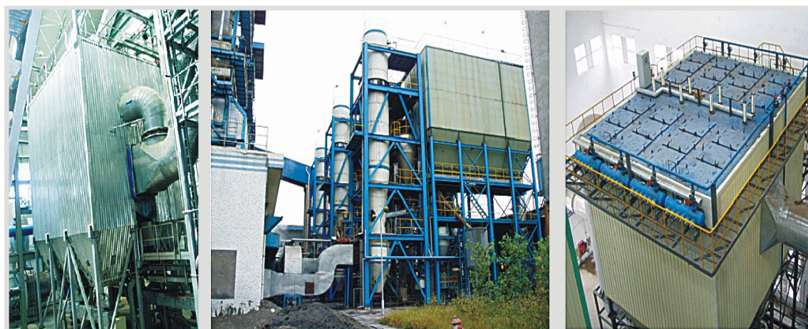
图 6-2 干法脱硫除尘一体化尾气净化处理设备产品
