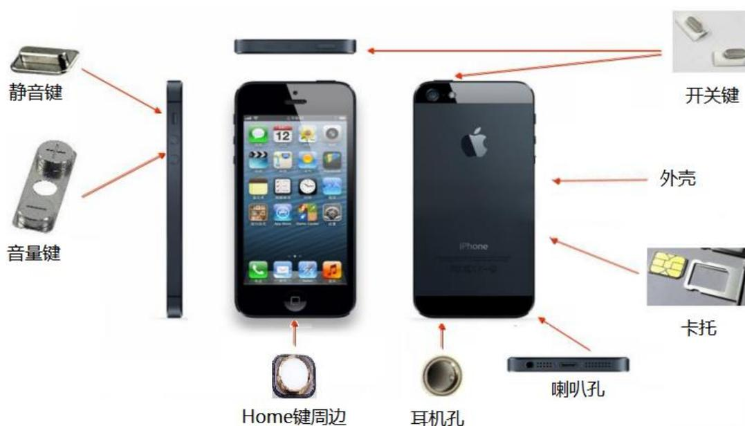
金属材料在智能手机零配件中的部分应用
