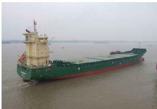
船型: 1,000箱集装箱船 主尺寸: 151.72m × 23.4m × 11.75m 载重吨: 13,000载重吨 入级: 法国船级社
