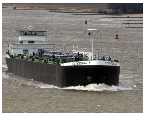
船型: 欧洲内河油船 主尺度: 135m × 13.5m × 5.32m 入级: 法国船级社
