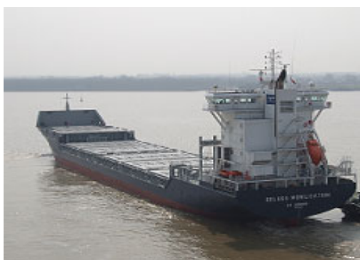
船型: 900箱集装箱船 主尺寸: 154.85m × 21.5m × 9.3m 载重吨: 10,600载重吨 入级: 法国船级社
