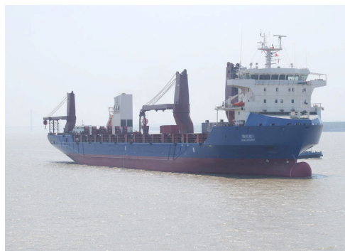
船型: 12,000吨重吊船 主尺寸: 153.8m × 23.2m × 12.8m 载重吨: 12,000载重吨 入级: 德国劳氏船级社
