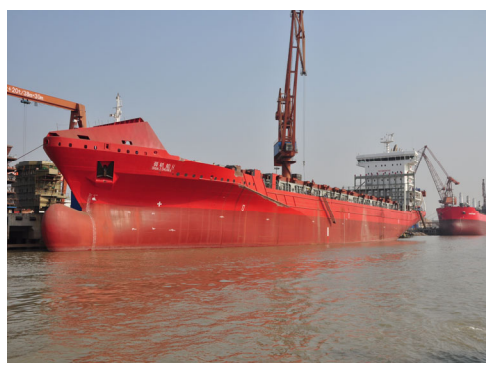
船型: 1,350箱集装箱船 主尺寸: 168.1m × 25.6m × 15.2m 载重吨: 20,200载重吨 入级: 德国劳氏船级社
