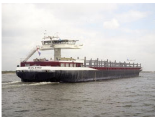
船型: 欧洲内河货船 主尺度: 135m × 17.35m × 5m 入级: 英国劳氏船级社
