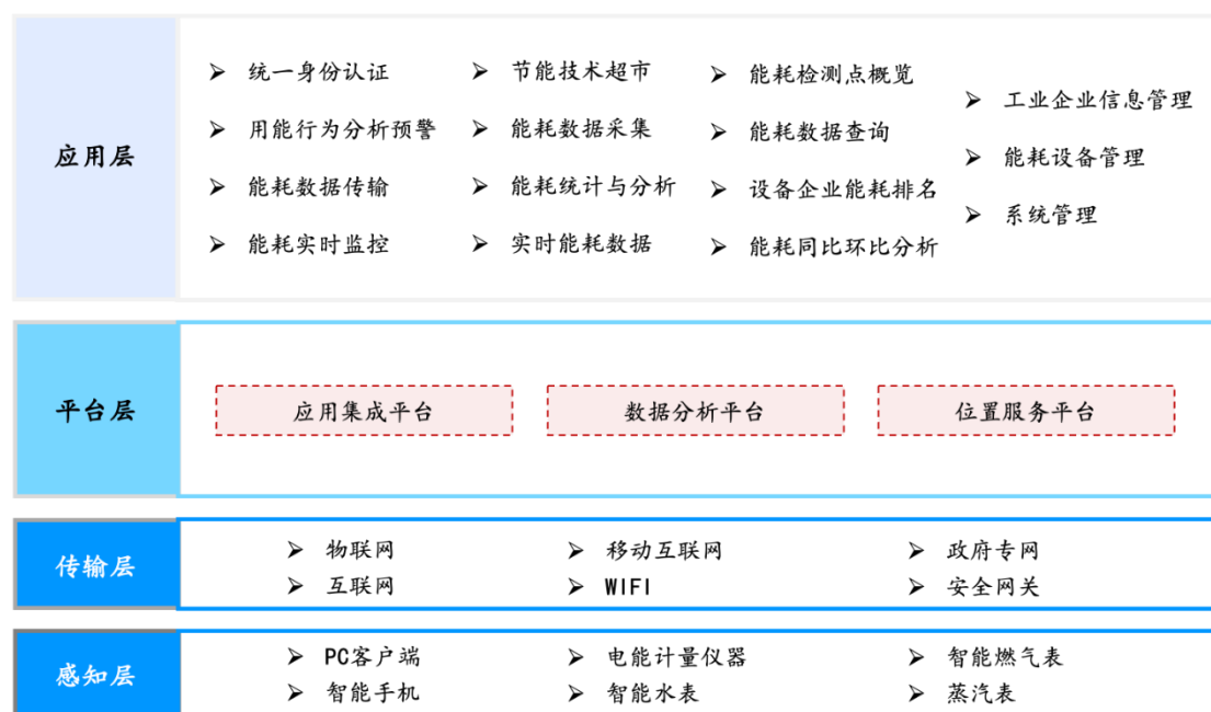
图：南宁市重点耗能企业能源实时监测系统项目层级架构图
