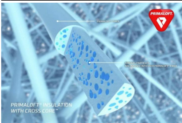
图 32: Primaloft 保温棉纤维示意图
