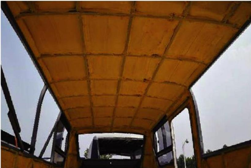
图 21: 气凝胶阻燃材料在客车中的应用
