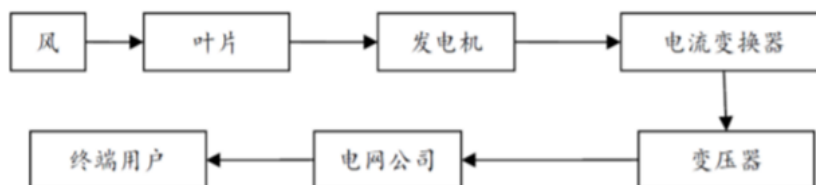
风力发电生产流程图
