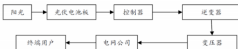
光伏发电生产流程图
