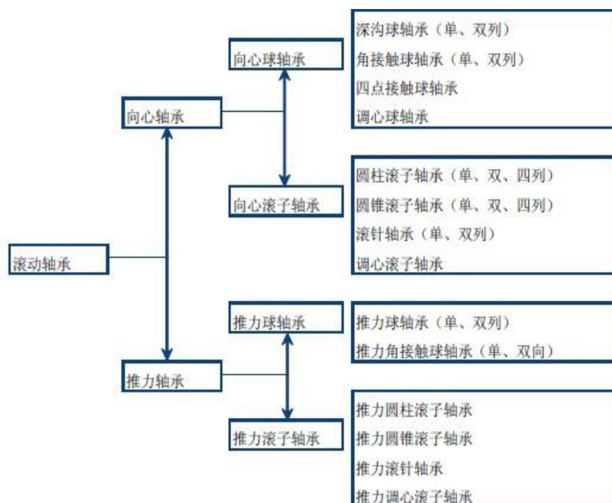
滚动轴承通常由外圈、内圈、滚动体和保持架组成。外圈和内圈统称为轴承
