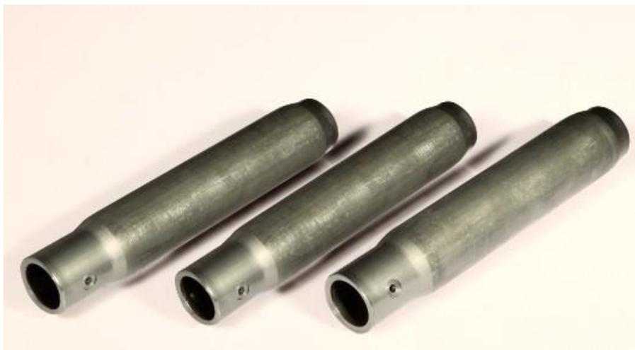
用于制造汽车安全气囊的专业钢管要经过严格的质量标准控制，并且必须要满足苛刻的尺寸及功能要求。它们的关键因素是纯净的炼钢工艺、机械特性及非常精密的壁厚厚度和偏心率公差。在汽车安全气囊气体发生器工作时，钢管在极端变化的变形率下承受着极高的应力。富立钢管与 AUTOLIV 和兴澄特钢联合研发的低碳高强度钢，即使在 (-60℃) 低温的条件下亦能承受冲击力，具有很高的韧性，亦能保证产品的高强度特性以及优异的抗爆裂和冲击韧性与高抗耐疲劳性。对钢材进行制管的生产过程中，富立钢管利用多年高端精密轴承钢管的技术底蕴进行专项攻关，掌握了生产的关键技术：
