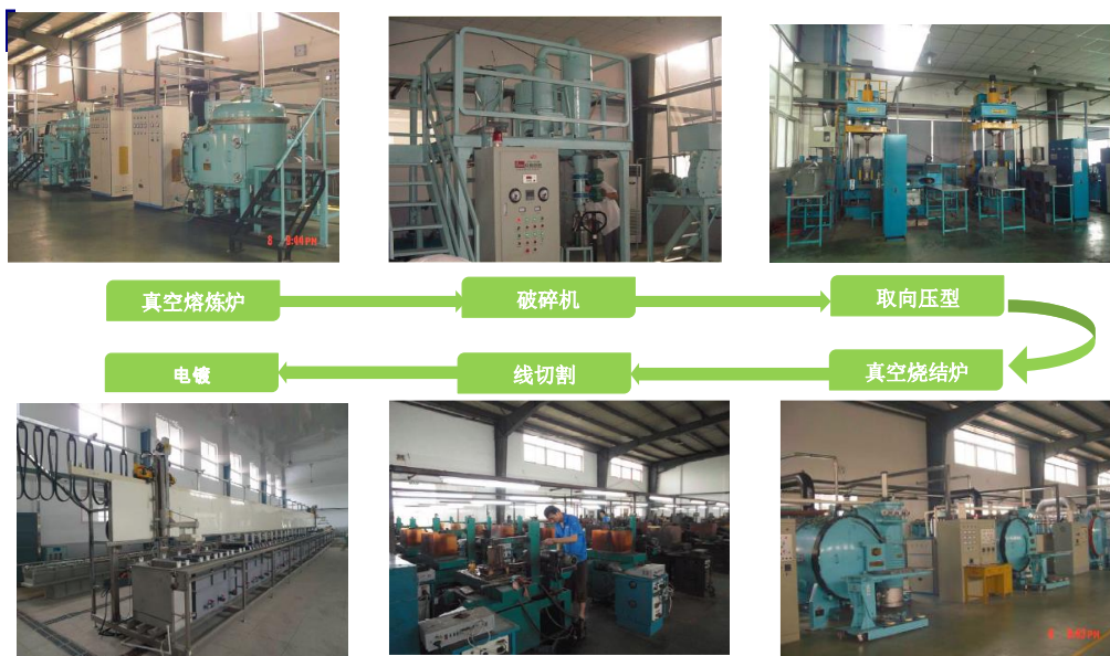
图 4. 烧结钕铁硼主要生产设备
