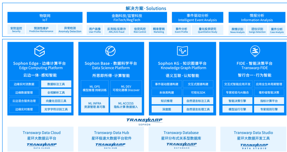
图 7：Sophon 架构示意图
