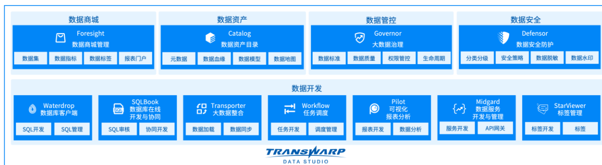
图 6：TDS 架构示意图
