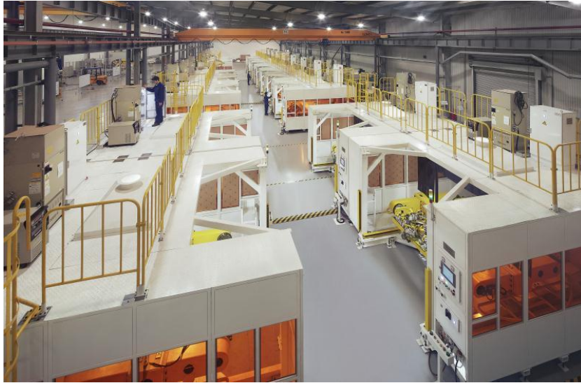
图：发行人建造的摩托车焊接生产线
