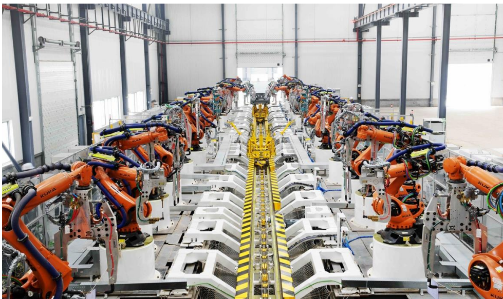
图：发行人建造的地板焊装生产线
