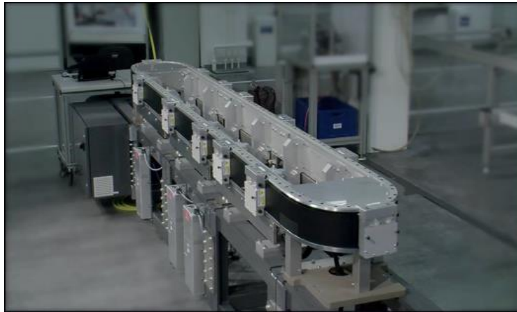
图：发行人建造的手机电池装配生产线（局部）
