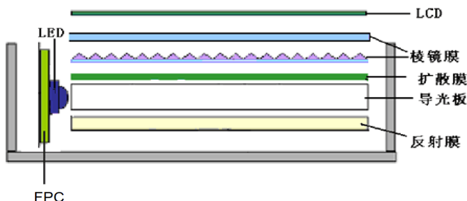
侧光式 LED 背光源结构图
