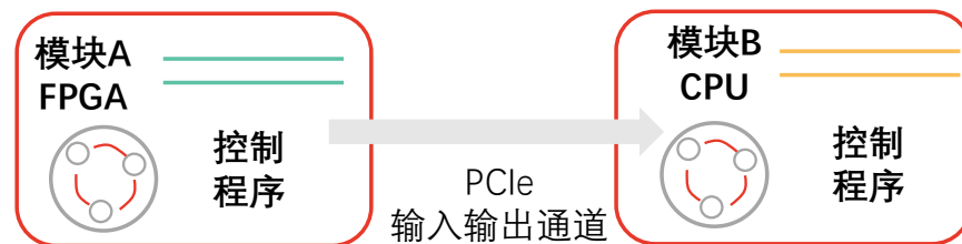
Click NP（FPGA）应用于云计算（通道连接CPU、FPGA）
