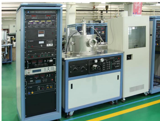
等离子体增强化学气相沉积设备图例
