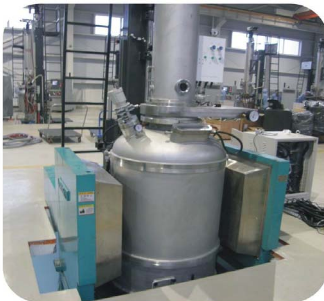
施加横向磁场的 CZ 生长炉
