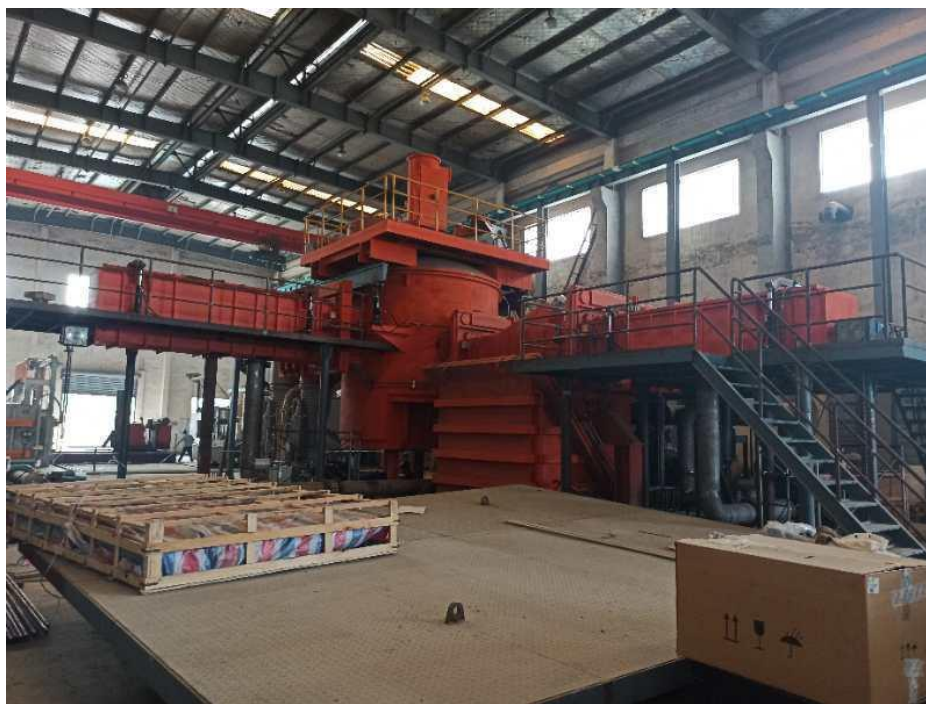
图. 江苏新中洲新购置的 3 吨真空熔炼炉
