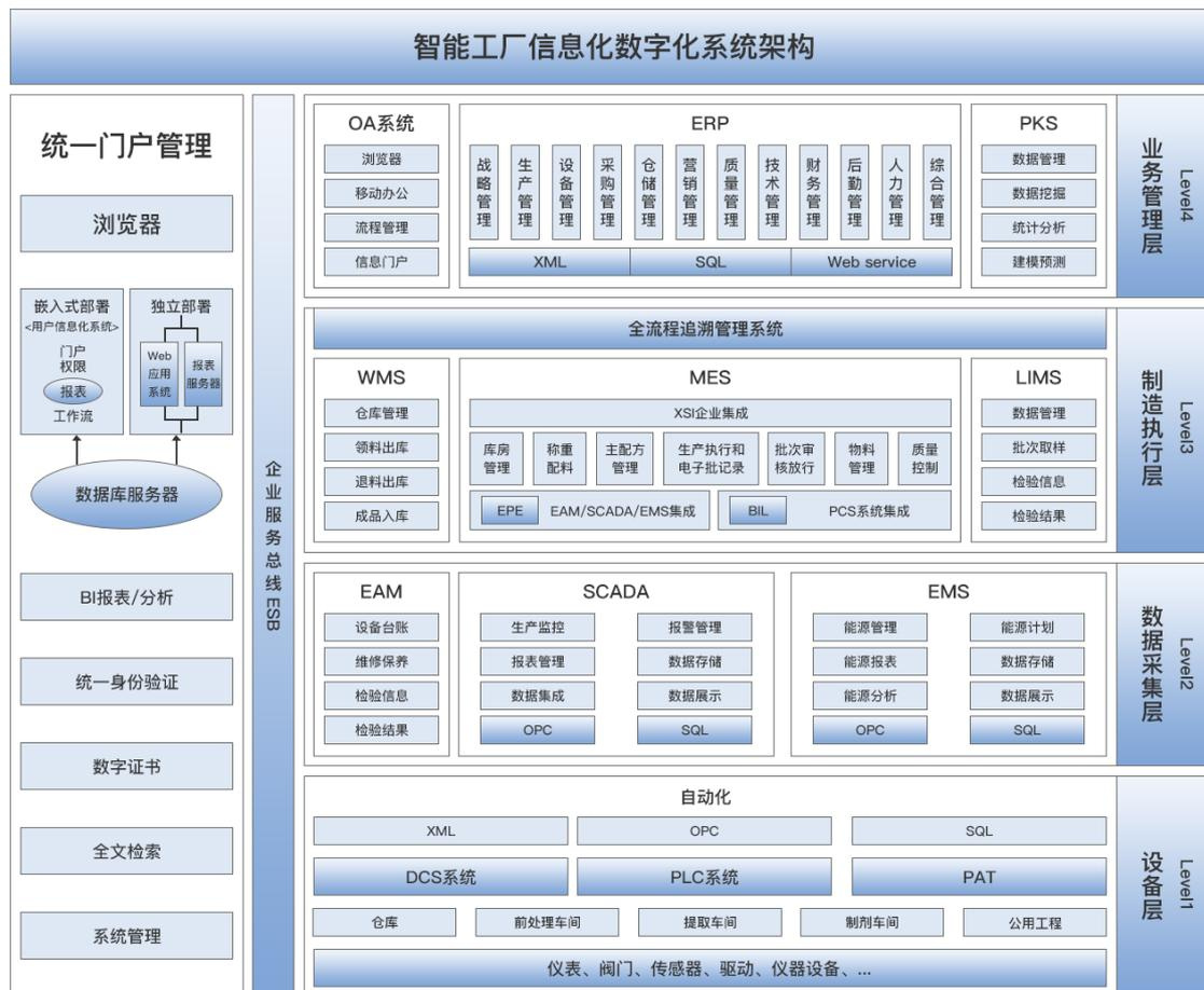
图示：智能工厂平台系统架构
