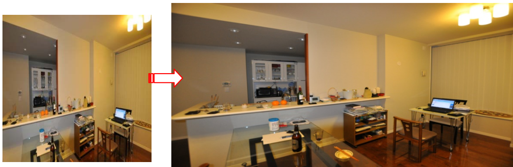
仙台某高层隔震住宅地震后室内物品无移动
