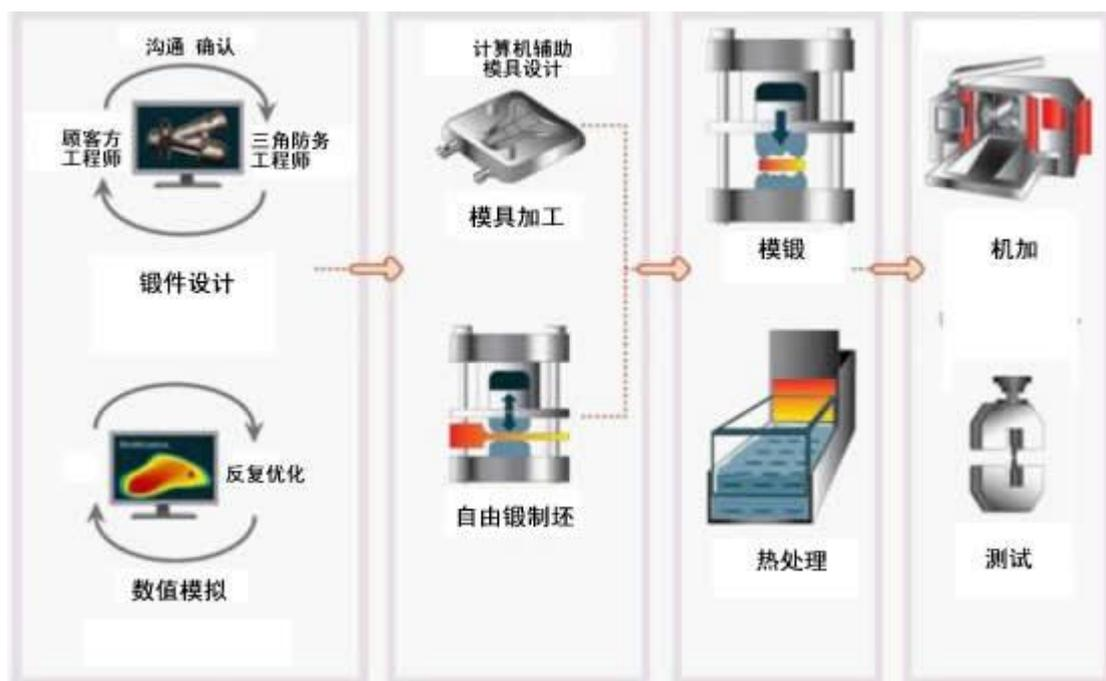
根据客户需求的不同或型号设计要求，部分产品加工工序会先经历自由锻工序再进行模锻工序，部分产品不需要后期的机加工序而直接以毛坯状态交付。
