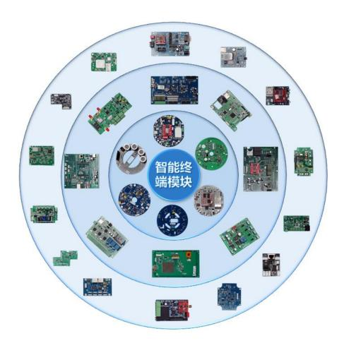
公司研发的嵌入式产品体系包括传感层、采集层和汇聚层产品组成,传感器层产品主要采集底层的数据,并通过传统的总线上报采集层,采集层主要通过有线和无线的方式采集大气、水、油烟、能耗以及监控类数据,并上报汇聚层,汇聚层主要进行数据的汇总、存储、加密传输、数据处理、智能分析以及数据应用和展示。
