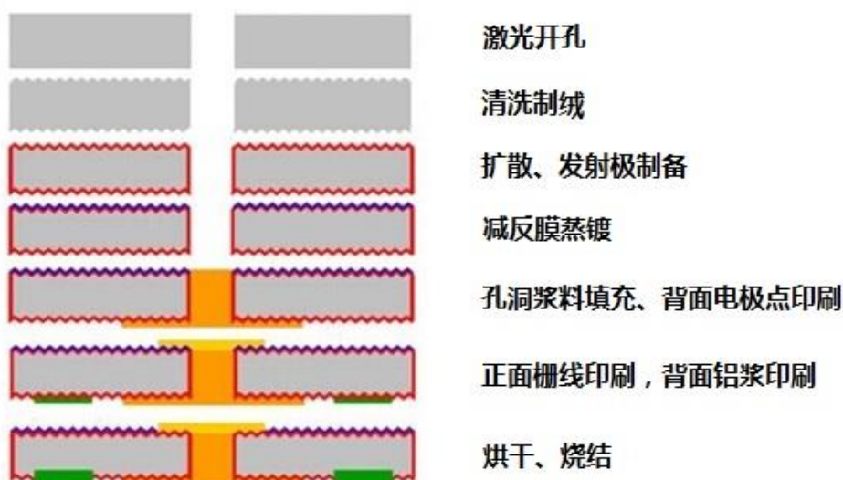
图：P型硅基MWT电池基本工艺流程
